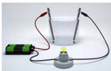
Слика 1.29 Апаратура за испитивање електричне проводљивости различитих супстанци
