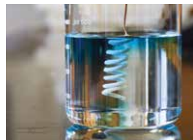
Слика 6.7 Реакција бакра са раствором сребро-нитрата
