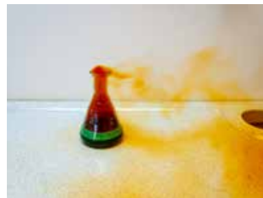
Слика 6.6 Реакција бакра са концентрованом азотном киселином
