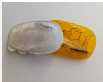
Слика 1.22 Грејач за руке који садржи презасићени раствор
