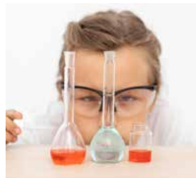
Слика 1.18 Важан део у поступку припремања раствора јесте допуњавање волуметријске тиквице до марке, при чему се ниво течности посматра у висини очију.
