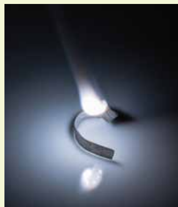
Слика 2.3 Сагоревање магнезијумове траке
